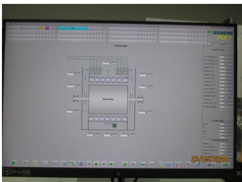
รูปที่ 3-43 อุปกรณ์เซนเซอร์ตรวจจับอุณหภูมิ ขดลวดของเครื่องกำเนิดไฟฟ้า
